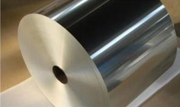
Foglio di alluminio, dallo spessore minimo di 5,5 my in poi, è l'ultima soluzione per la fornitura di barriera totale contro luce, ossigeno e umidità. Utilizzato come strato intermedio in diversa struttura complessa è ampiamente usato per:
